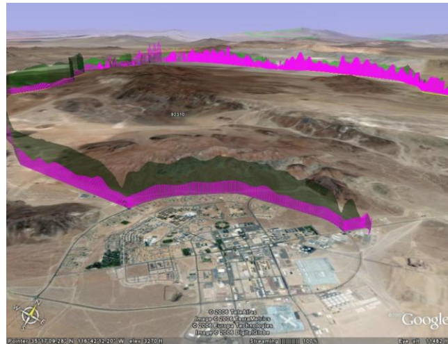
Fig. 6: Latitude and longitude plot of speed (green) and RMS acceleration (pink) values
